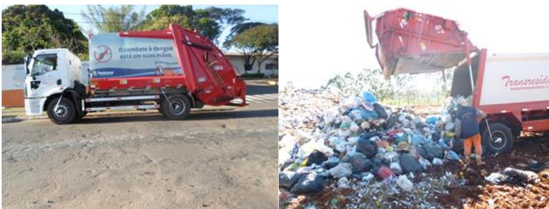
Figura 01 – Caminhão compactador da coleta domiciliar.
