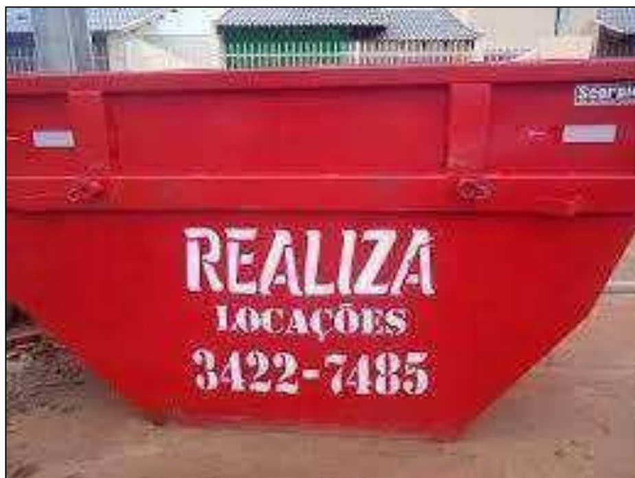
Figura 69: : Caçamba de armazenamento de RCD
