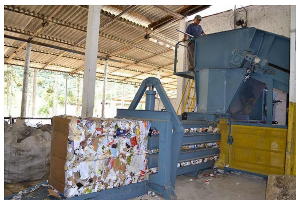
Figura 237. Prensa semiautomática da UVR Campo Magro Fonte: IPCC, 2015.
