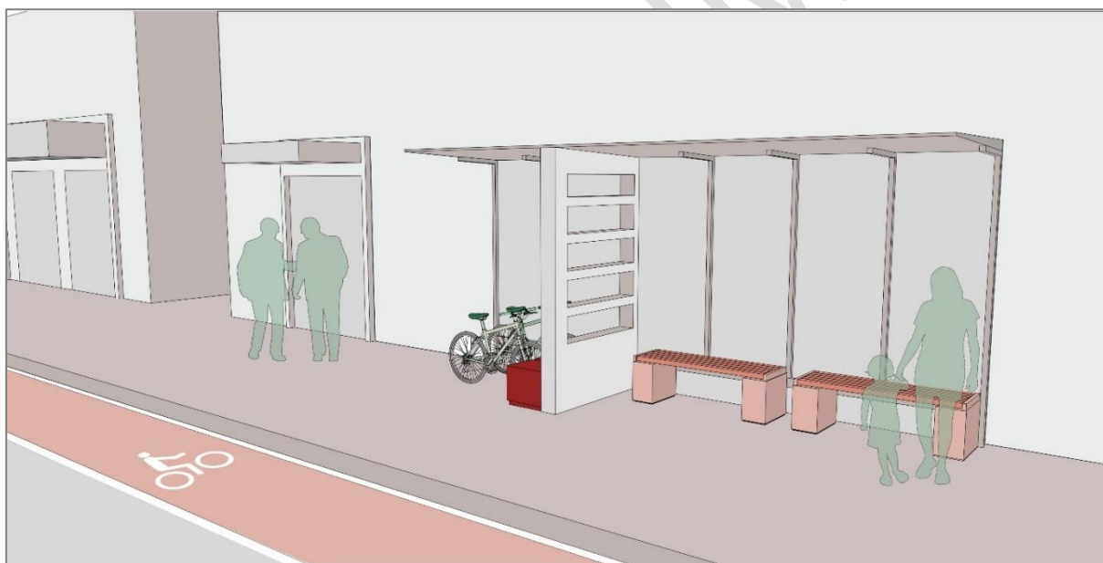
Figura 4 – Estação de transferência: ponto de parada adaptado com paraciclo
