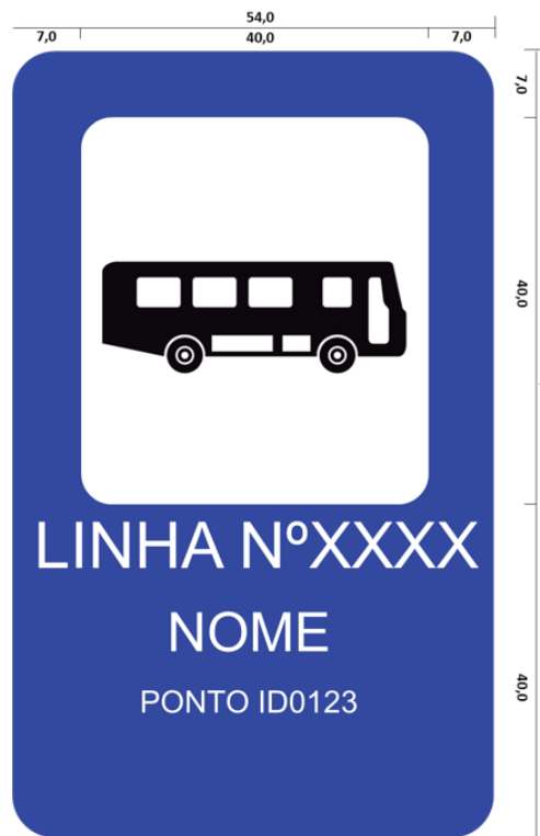
Figura 1 – Modelo de sinal indicativo de servios auxiliares de "Ponto de Parada" (S-14)
