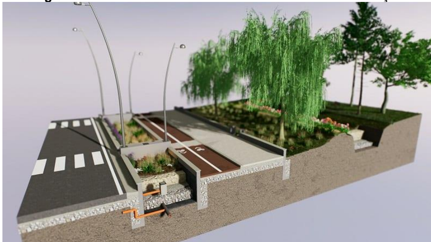
Figura 10: Detalhamento de Sistema de Jardim de Infiltração
