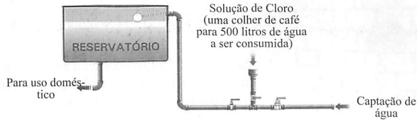
FIGURA 1 – CLORAÇÃO DE ÁGUA DE RESERVATÓRIO
