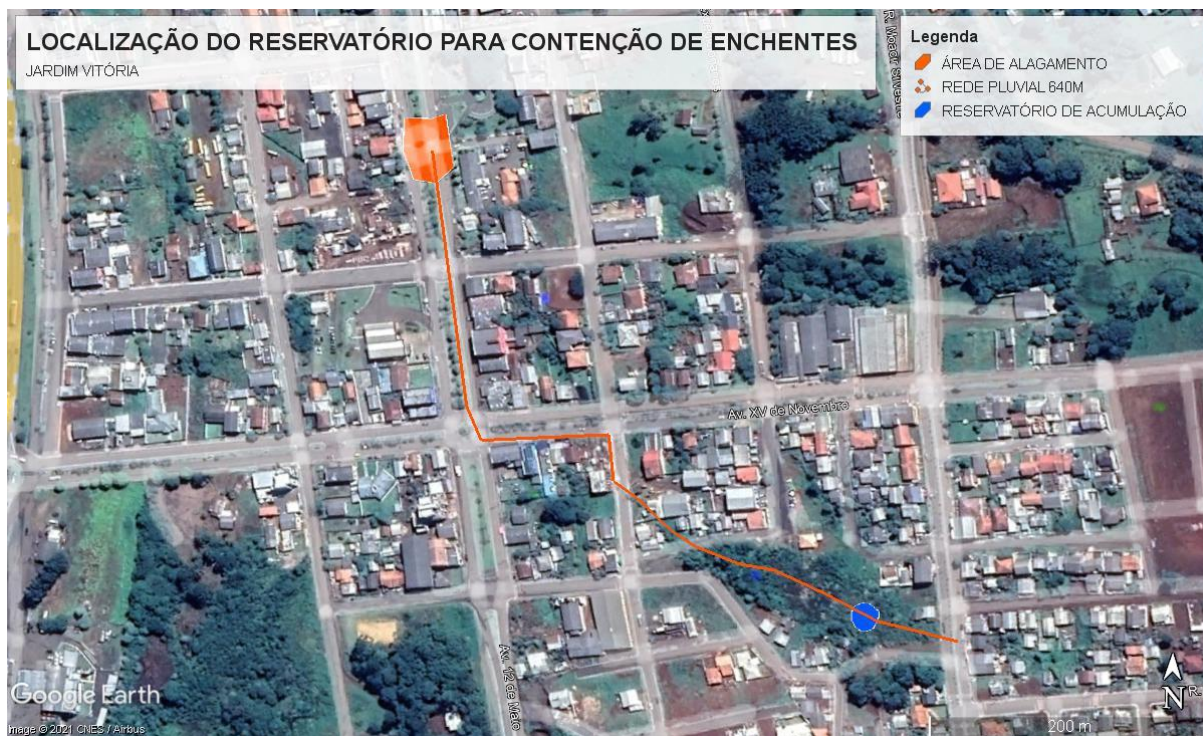
Figura 25- Localização da Bacia de Contenção; Fonte: Prefeitura Municipal de Turvo-PR
